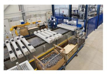
**Bildunterschrift 3:** Das hochmoderne Spätentschalungssystem mit Robotertechnologie produziert Betonschwellen für das deutsche und europäische Eisenbahnnetz (Foto: PCM RAIL.ONE AG / R. Mederer).
